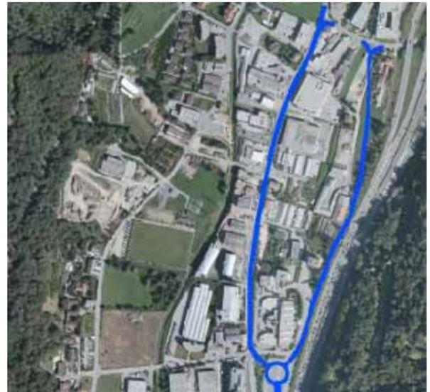
Sull'estremo opposto, in corrispondenza di via al Piano, è prevista una rotatoria del diametro complessivo di 50 metri che, sulla base delle simulazioni effettuate, risulta in grado di garantire un corretto smaltimento dei flussi previsti.
