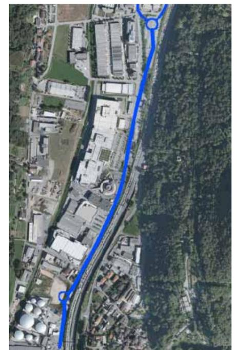
(accelerazione e decelerazione). Al fine di evitare le manovre di svolta a sinistra, l'ingresso da Sud e l'uscita in direzione Nord avvengono mediante sottopasso della Strada Cantonale.
